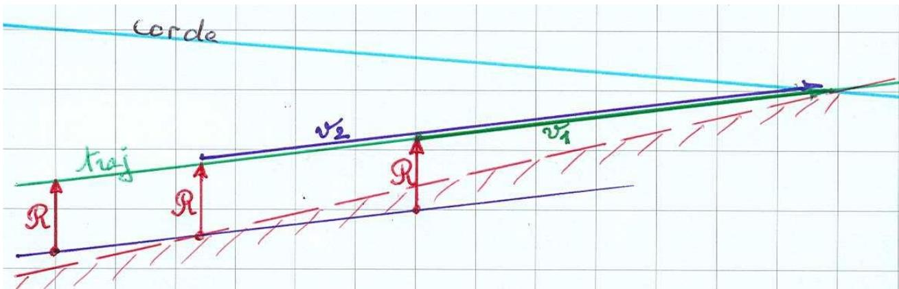
Avec  $V_1$ , nous risquons le décrochage pour une rafale montante de force  $\vec{R}$ .
