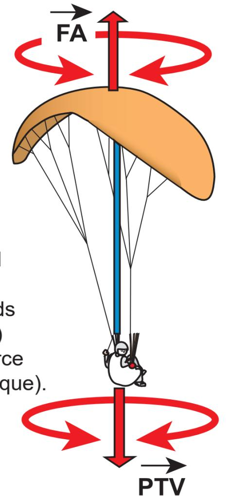
Le lacet est un mouvement sur l'axe vertical qui aligne le PTV (Poids Total Volant) et la FA (Force Aérodynamique).
