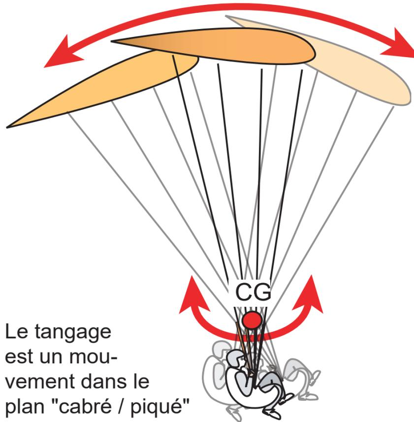
Le tangage est un mouvement dans le plan "cabré / piqué" et en rotation autour du centre de gravité.
